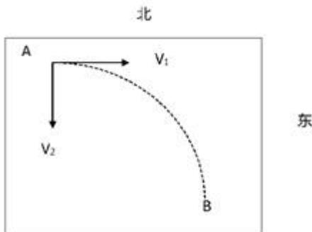
根据题意，小球与桌面相对静止，则小球和桌面同时向东做匀速直线运动，由小球相对桌面的运动轨迹可知，小球相对桌面的运动速度可以分解为正东方向和正南方向的两个分速度，由于桌面是光滑的，对小球没有摩擦力，小球在惯性作用下继续保持匀速向东运动（即火车原有的速度）。以小球作为参照物，火车和桌面的运动速度可分解为正西方向和正北方向；
